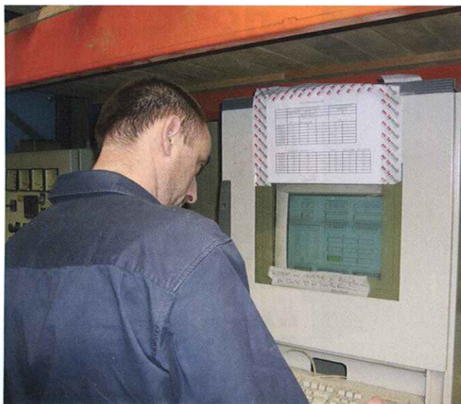
Un ordinateur pilote l'intégralité du cycle de cuisson des disques réalisée dans les huit fours électriques, y compris la phase de refroidissement.
